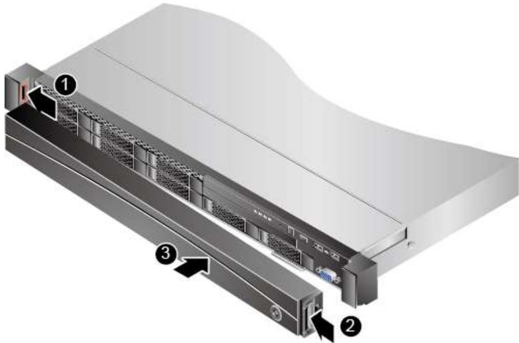
**Шаг 3** Заблокируйте переднюю панель, повернув ключ против часовой стрелки, и извлеките ключ. См. Рис. 5-4.
