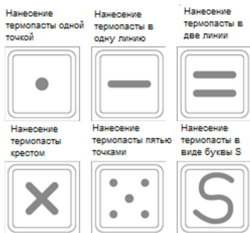
Слой термопасты должен по толщине соответствовать листу обычной бумаги. На Рис. 5-39 показан слой равномерно распределенной термопасты. Убедитесь, что термопаста нанесена равномерно и полностью распределена по поверхности.
