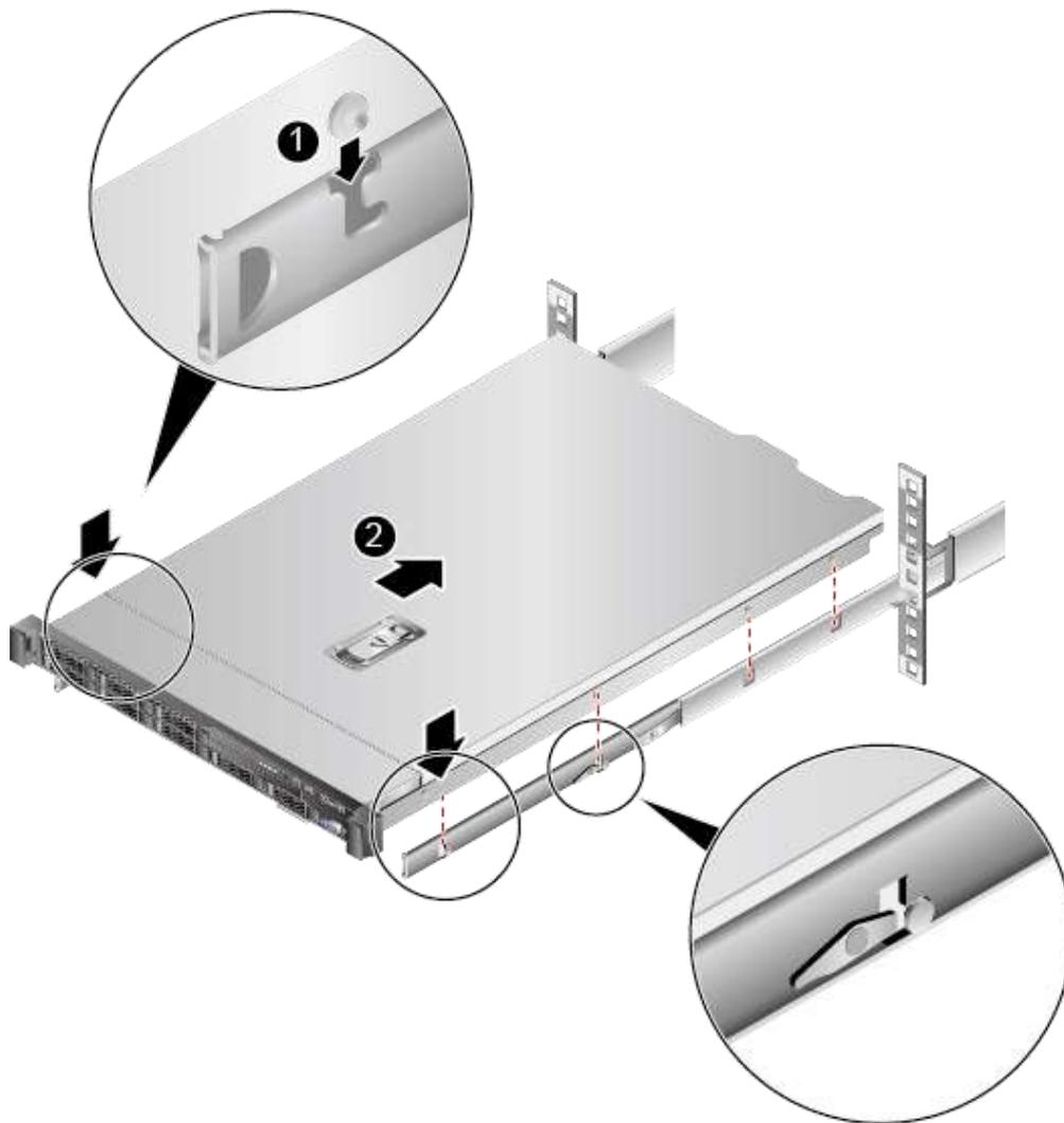
3. Нажмите кнопки разблокировки фиксатора с двух сторон и продвиньте сервер в шкаф по нерегулируемым направляющим. См. Рис. 4-10 (1) и (2).
