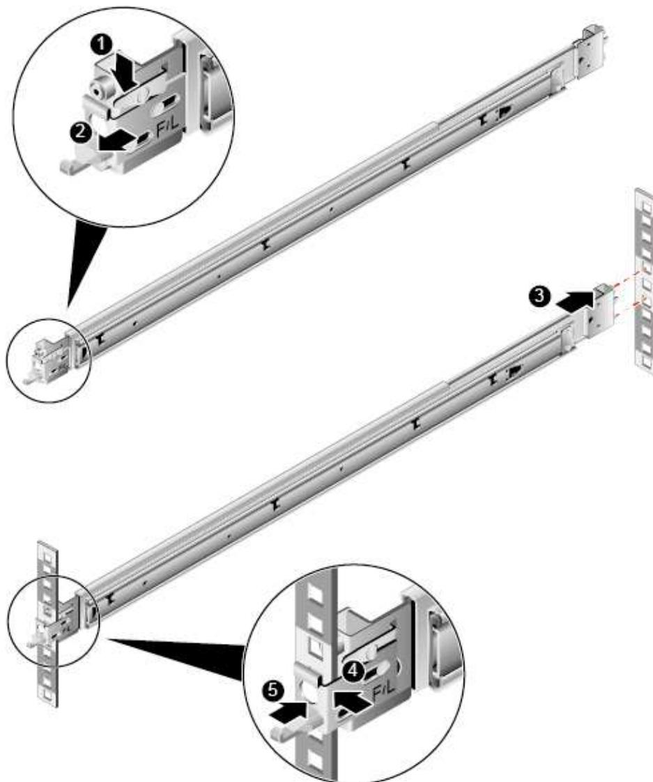
2. Вставьте установочные штифты заднего конца направляющей в квадратные отверстия шкафа. См. Рис. 4-7 (3).
