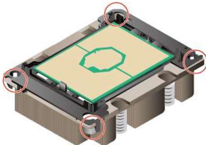
**Шаг 18** Снимите защитную крышку процессора. См. Рис. 5-42.
