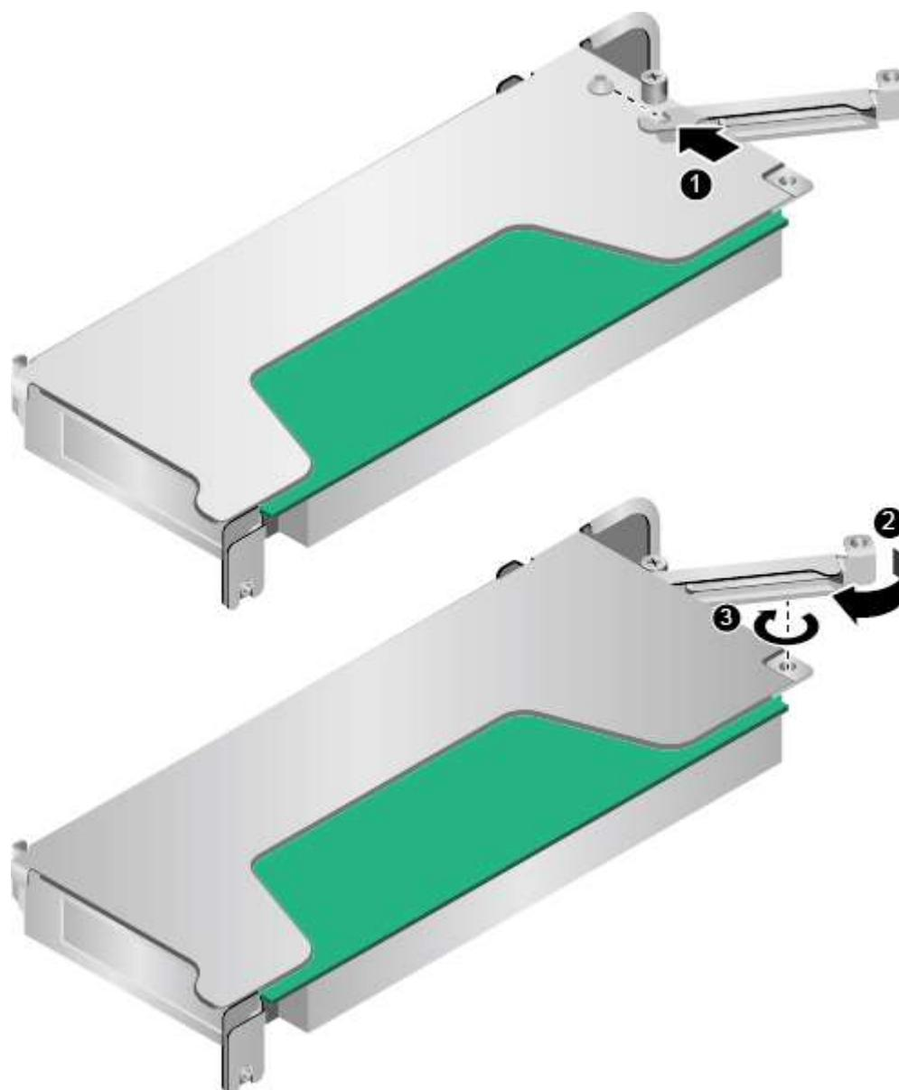
Рис. 5-16 Установка фиксирующих элементов (2)
