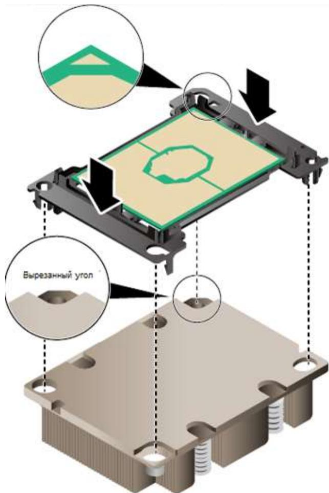
**Шаг 17** Поместите теплосъемник на рабочую поверхность и убедитесь, что держатель ЦП надежно установлен. Нажмите на него, чтобы закрепить все приподнятые части. См. Рис. 5-41.
