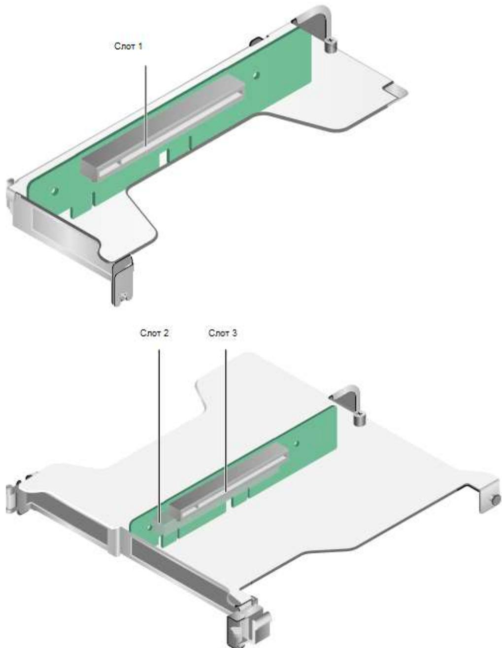
На Рис. 2-19 показаны слоты PCIe, расположенные на задней панели 1288H V5.
