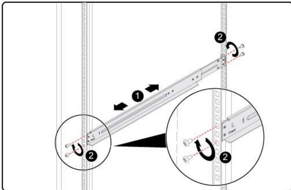
2. Зафиксируйте направляющую, затянув четыре винта с передней и задней сторон. См. Рис. 4-5 (2).
