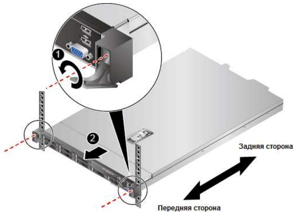
**Шаг 5** Извлеките сервер из шкафа, двигая по направляющим. См. Рис. 3-1 (2).
