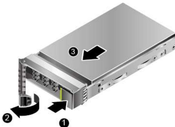
**Шаг 4** С помощью рычажка выталкивателя вытащите жесткий диск наружу примерно на 3 см. См. Рис. 5-5 (2). Подождите не менее 30 секунд до полной остановки работы жесткого диска и извлеките его. См. Рис. 5-5 (3).
