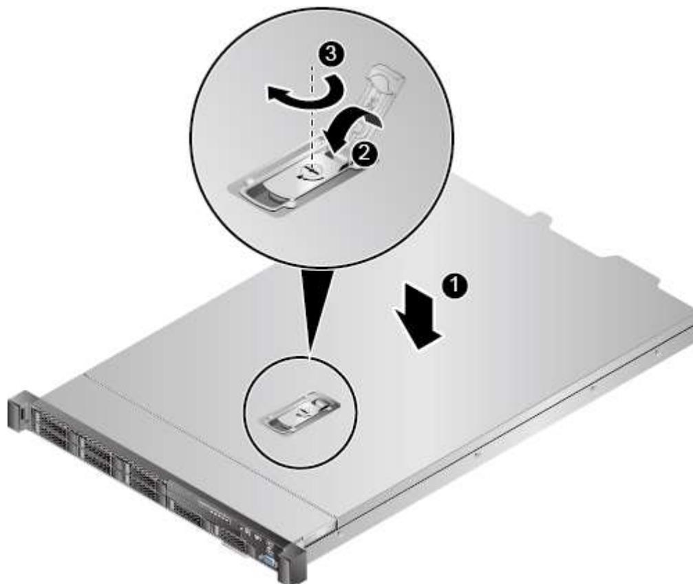
**Шаг 3** Затяните винт с помощью плоской отвертки, чтобы закрепить ручку. См. Рис. 3-6 (3).
