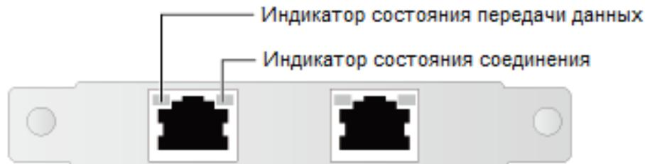
**Рис. 2-9** SM210/SM212 с четырьмя электрическими портами GE
